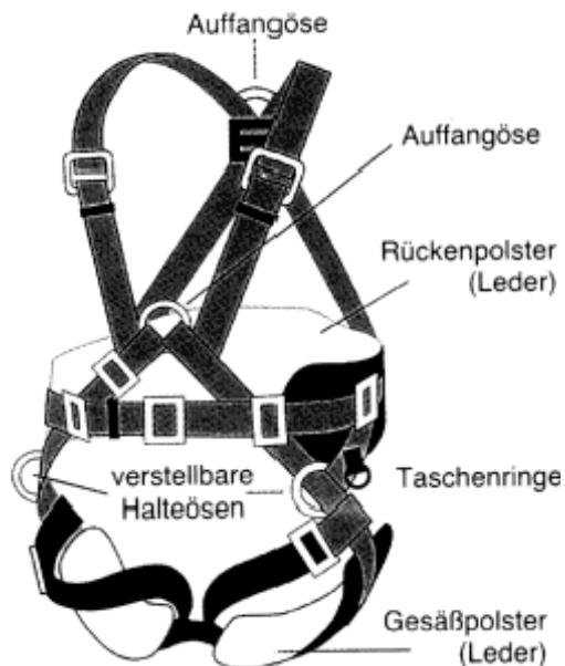
Bild 9: Auffanggurt mit vorderer und rückseitiger Fangöse sowie seitlichen Halteösen. Der Gurt ist zusätzlich mit einem Rückenpolster versehen
