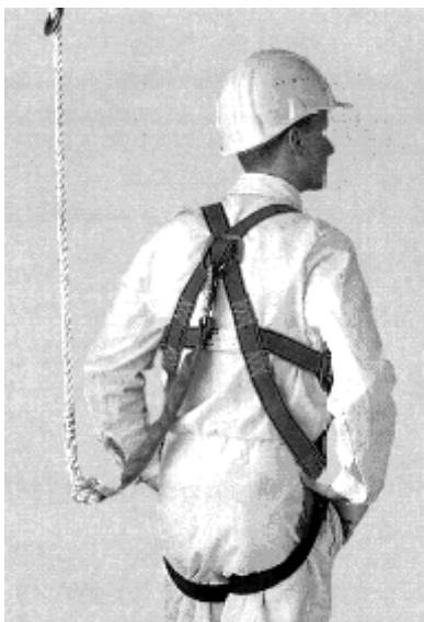
Bild 7: Beispiel der Benutzung des Auffangsystems Verbindungsmittel mit Falldämpfer und Auffanggurt
